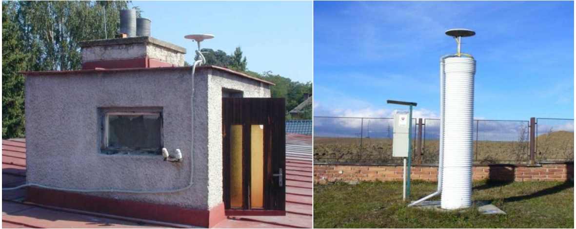
obr. 1.1 Stabilizácia bodov SKPOS (Droščák, 2010)
