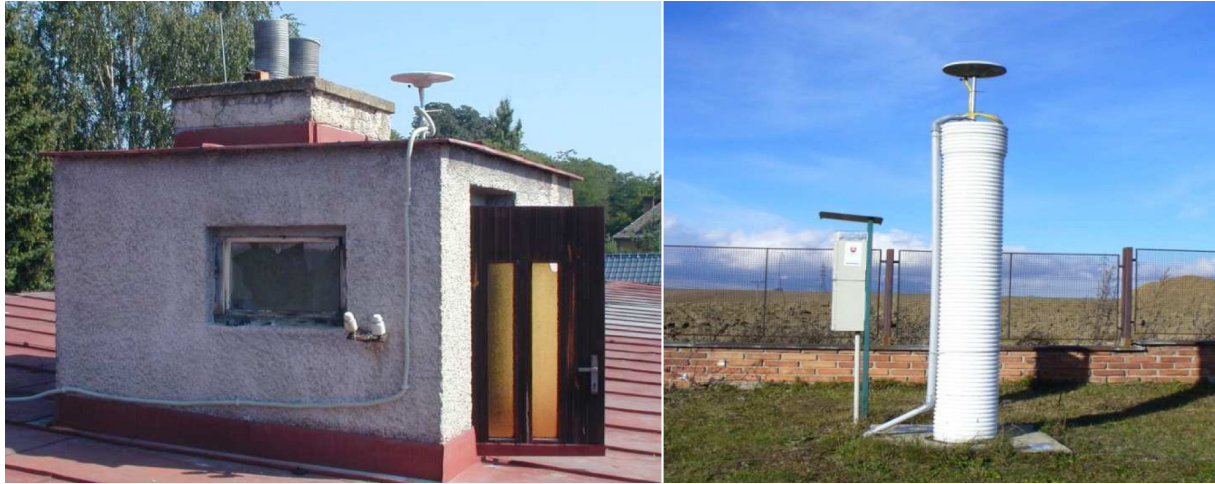
Obr. 1 Stabilizácia bodov SKPOS (Droščák, 2010)
