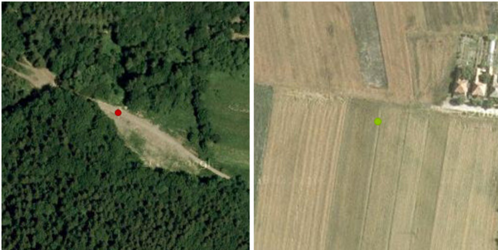
Obr. 12 Terénne prekážky pri prijíme 4 satelitov (vľavo) a 20tich (vpravo)
