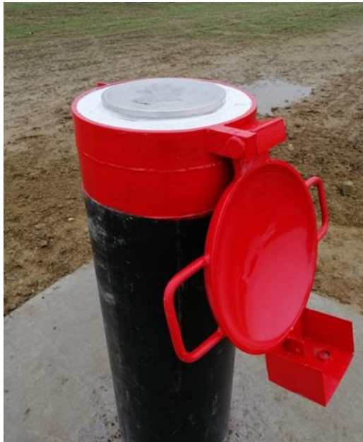
Bod kalibračnej základnice s centračnou platňou a ochranným krytom
