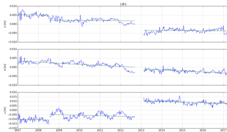
Obr 4. Odhad lineárneho trendu spoločne so skokmi časových radov topocentrických súradníc stanice LIE1 (Liesek) v systéme ETRS89.
