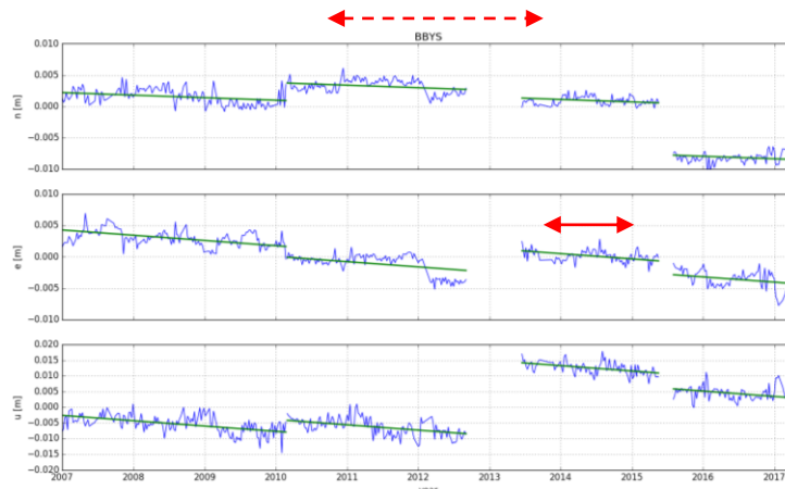
Obr 7. Podmienky minimálnej dĺžky časového radu pre zahrnutie do spracovania. Neprerušovaná šípka reprezentuje minimálnu dĺžku čiastkového časového radu oddeleného skokmi v súradniciach. Prerušovaná šípka je minimálna dĺžka celého časového radu (suma dĺžok čiastkových akceptovaných časových radov)
