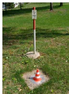
Obr. 8 Gravimetrická mikrozákladnica Modra-Piesok (vľavo) a ukážka jedného z jej bodov (vpravo).
